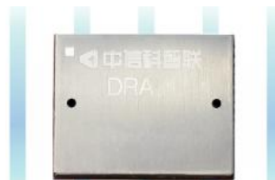
图 3-6 车规级 C-V2X 射频功率放大模组 DRA 系列模组
