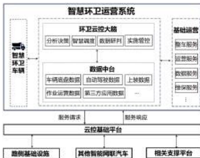
图 4 车路云一体化体系中智慧环卫应用系统组成
